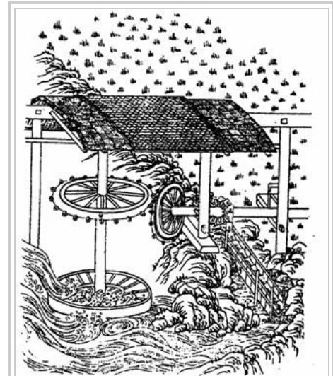
图 4-85 水转翻车 (引自《明》宋应星《天工开物》)
